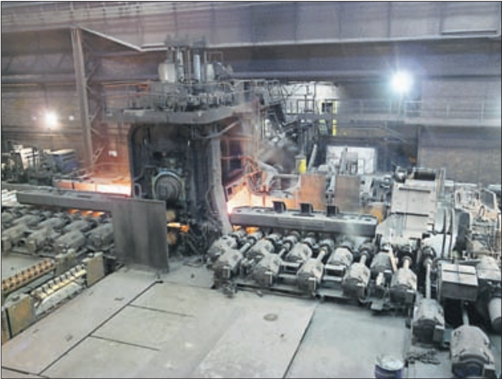
Slika obstoječega ogrodja Blooming med valjanjem predtrakov.
