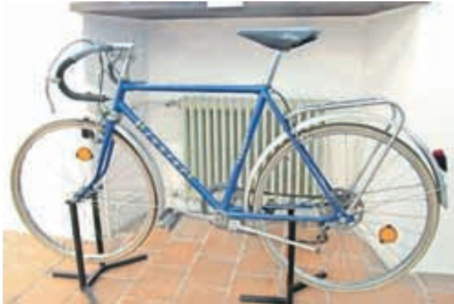
Rogova mala petka je izdelana iz pločevine, narejene v hladni valjarni Bela.
