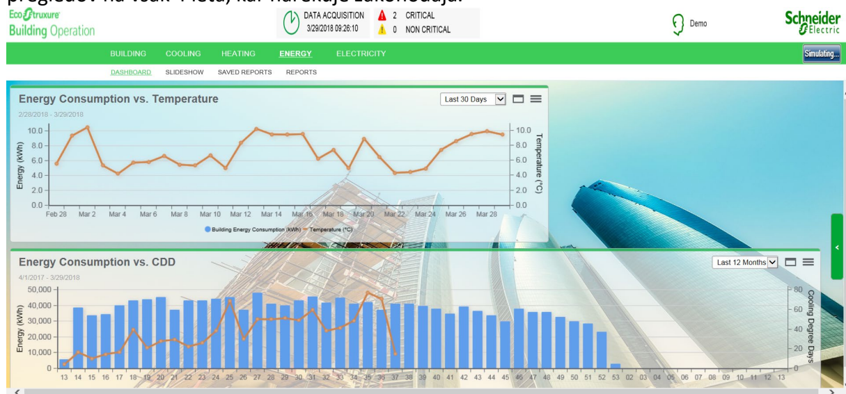
Slika 49: Primer sistema za spremljanje rabe energije – raba ZP glede na zunanjo temperaturo
