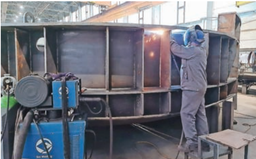
Zaključna dela na okvirju nove elektroobložne peči v delavnici podjetja KOV
